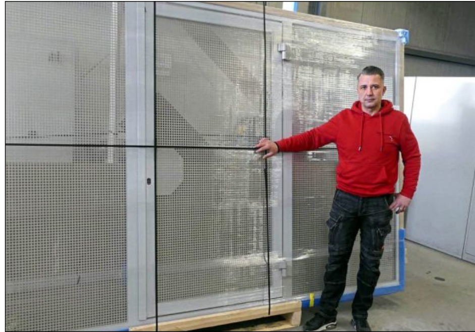
EINE ZWEITE FLUCHTTÜR hat dieses Tiefgaragenrolltor, das in Sebastian Moczygebas Firma für den Einbau vorbereitet wird. Foto: Werner
